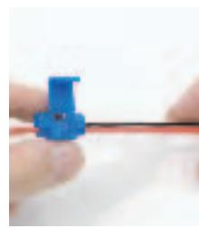
Colocar los cables en el conector
