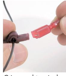
Crimpar el terminal aislado y conectarlo a la derivación
