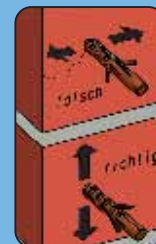
Tener en cuenta la posición de la parte de expansión en la proximidad del borde
