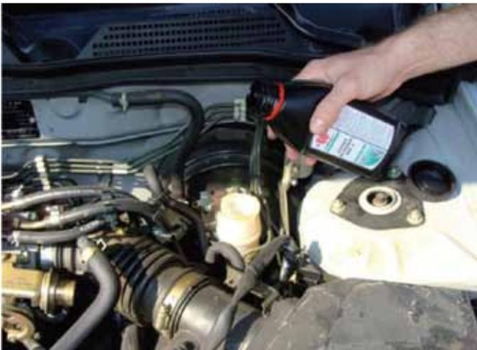
**Líquido 100% sintético para el llenado de circuitos de frenos y embragues de automóviles y V.I.**
