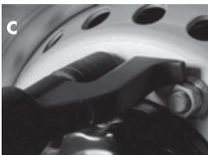
Acople la herramienta con el cubo de impacto en la tuerca o en el tornillo y apoye el brazo auxiliar en una superficie rígida.
